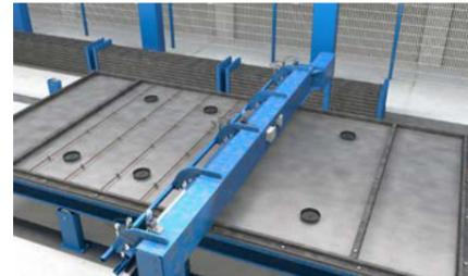
Bewehrung wird durch Quereisenautomat eingebracht.
