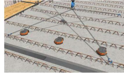
Fertigteil wird geliefert und montiert.
