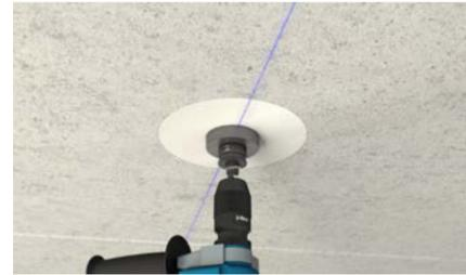
Einfaches Ausfräsen bei Verwendung eines Hartmetallfräsers. Standard-Bohrkronen ungeeignet.
