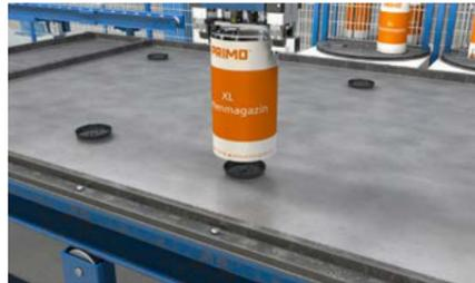
Frontteile werden automatisiert auf dem Schaltisch positioniert.
